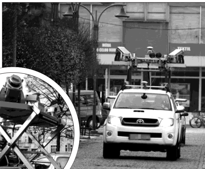
Automobil opatřený senzory skenuje centrum Bohumína. Rychlost jízdy závisí na hustotě výstavby, při snímání dálnice může jet i rychlostí 120 km/h. Systém vytváří kompletní 360° pohled na snímanou oblast a zachytí každý detail. Dole ukázka jednoho z výstupních formátů skenování. Podobně bude vypadat i Bohumín. Foto: Pavel Čempěl
