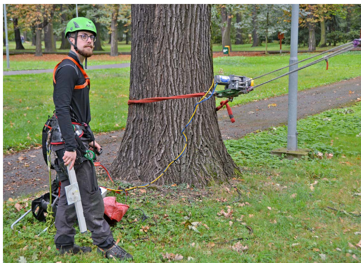
Odborníci podrobili v říjnu vytipované stromy tahovým zkouškám.
