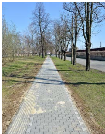
Jeremenkova dostala klasickou zámkovou dlažbu pro pěší. V Jiráskově je nově dlažba zatravnovací a pojízdná. Mohou na ní parkovat i auta.
